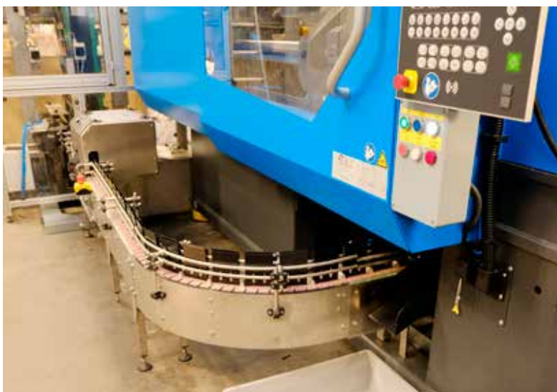
De gespuitsgiete onderdelen worden gelijk afgevoerd.
